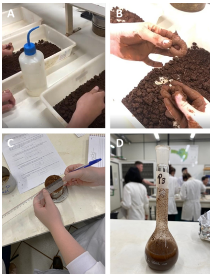
Figura 3. Imagens da prática de laboratório com determinações de consistência (A, B); densidade do solo (C) e de partícula (D). Fonte: Elaborado pelos autores (2024).
